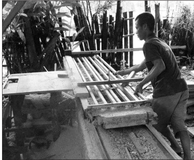
Chiếc máy xẻ gỗ cải tiến của anh Trương Văn Thủy giúp tiết kiệm thời gian và nhân công.
